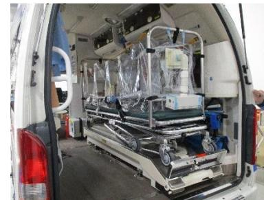
ピニールの内側の空気を常に換気し特殊フィルターの搭載で、ウイルスの99.9995%以上を除去して排気します。
